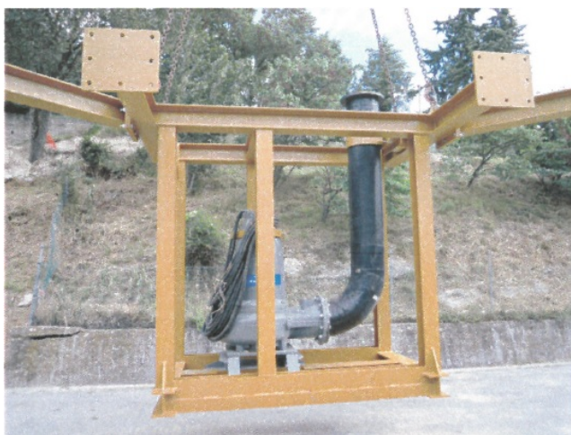
Foto 1 e 2: la struttura per il fissaggio della pompa
