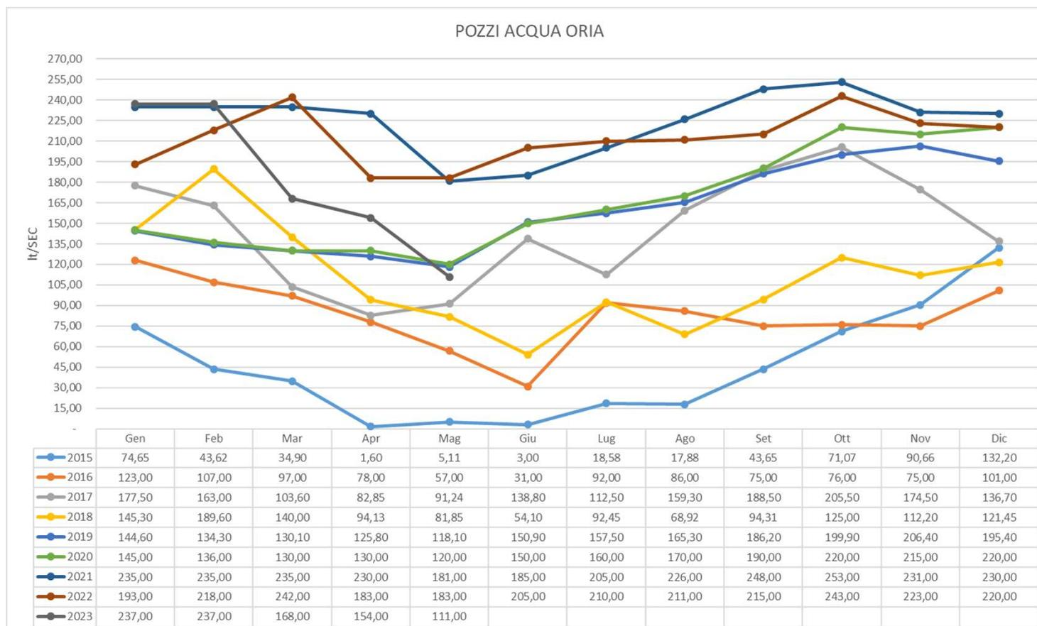
Sono utilizzabili n.6 pozzi ognuno con una capacità di emungimento di circa 50 L/s; i pozzi non vengono mai utilizzati contemporaneamente ma vengono attivati secondo la necessità dell'utenza ed utilizzati come integrazione ad altre Sorgenti nel **sistema idrico interconnesso Gran Sasso-Acqua Oria** e nel **sistema idrico interconnesso Chiarino-Acqua Oria**.
